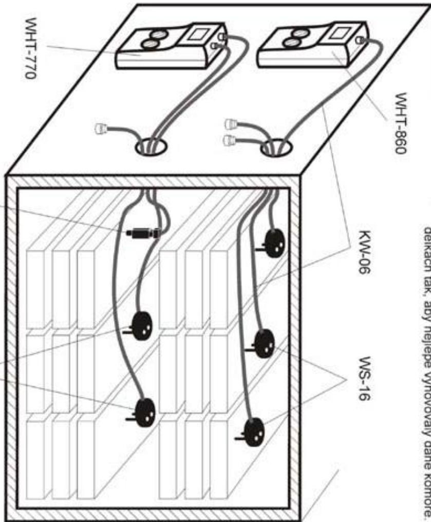
Soupravy jsou určeny pro rychlé a pohodlné zjištění vlhkosť dřeva, teploty vzduchu a cím nákladům a jednoduchosti jsou vhodné zejména do malých sušicích komor drobných dřevozpracujících firem.
